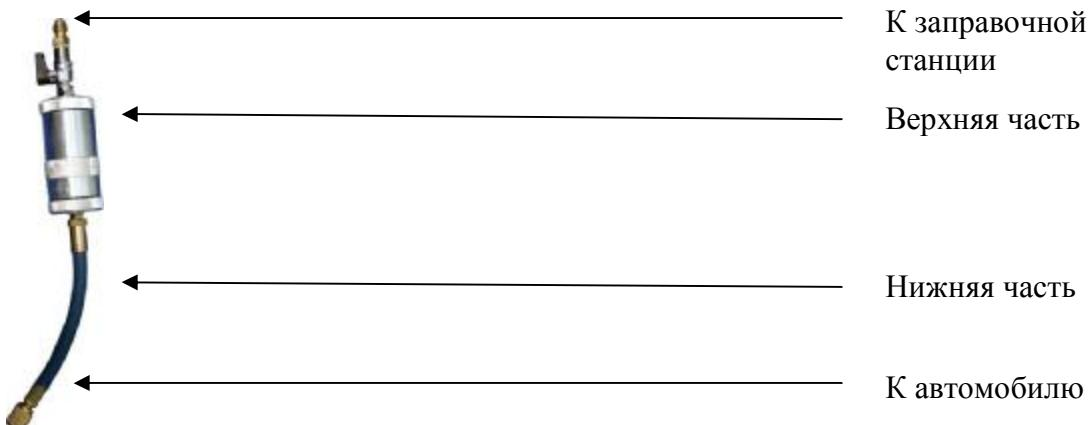
Если при заправке систем кондиционирования требуется заправить или дозаправить систему маслом, в этом случае возможно использование заправочного цилиндра (приобретается отдельно). Подсоединение заправочного цилиндра возможно к любому из шлангов до процедуры вакуумирования. Заправку масла лучше производить через линию низкого давления. Для этого необходимо:
