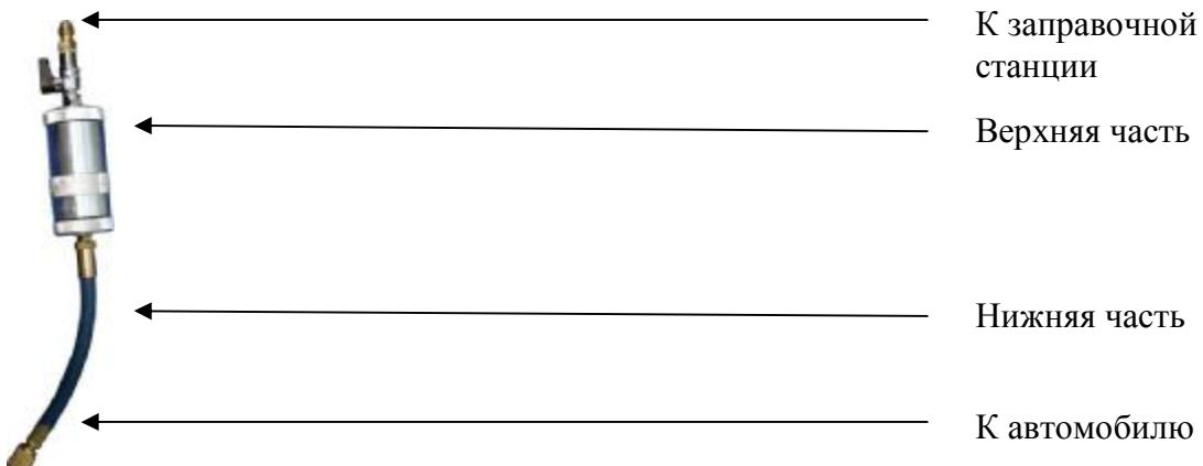
Если при заправке систем кондиционирования требуется заправить или дозаправить систему маслом, в этом случае возможно использование заправочного цилиндра для масла (приобретается отдельно). В зависимости от обслуживаемой Вами системы, используются цилиндры разных объемов. Подсоединение заправочного цилиндра возможно к любому из шлангов до процедуры вакуумирования. Заправку масла лучше производить через линию низкого давления. Для этого необходимо:
